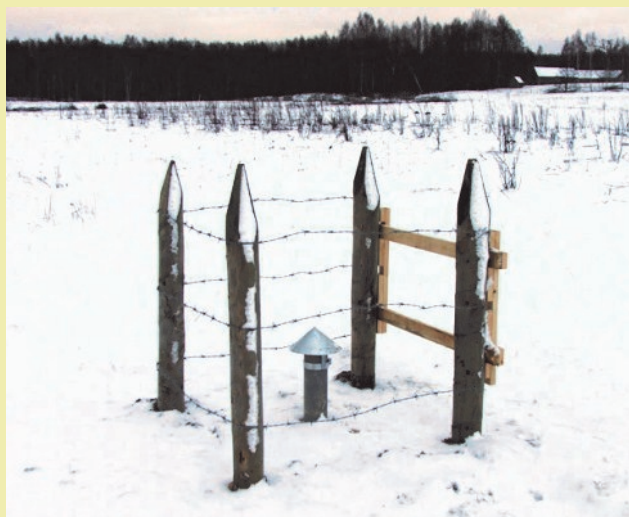
Gruntsūdens līmeņa mērījumu aka ar iežogojumu.
