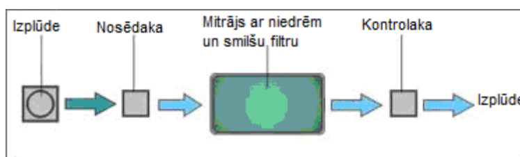
Horizontālā notekūdeņu plūsmas mākslīgajā mitrājā – niedru dobē
