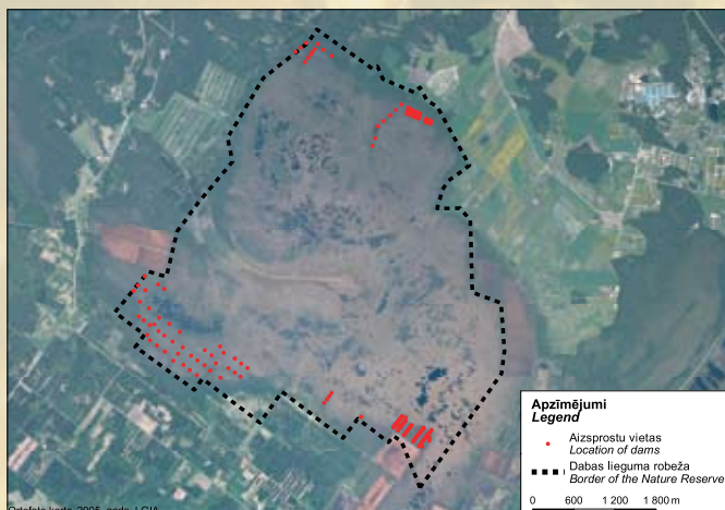
Trīs projekta teritorijās pēc hidroloģiskā novērtējuma tika plānoti un uzbūvēti aizsprosti uz meliorācijas grāvjiem. In the three project sites dams were planned and build on the drainage ditches.
